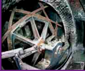
Ventilateur Guibal © Vincent Vincke
